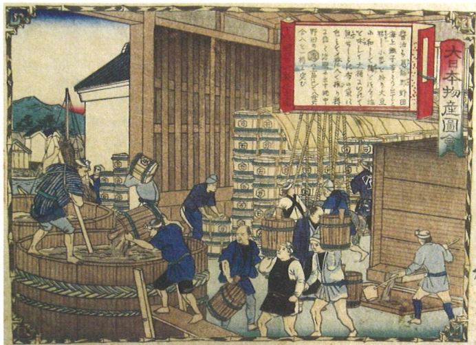
「 しもとうさ 下総国醤油製造之図」 1877 (明治10)年に、3代歌川 うたがわひろしげ 広重が近世の醤油製造の様子を描いた錦絵。小麦・大豆に こむぎ 麴を加え、塩をたして大桶に入れ、熟成させてもろみとし、 あつち 圧搾して醤油を得る。樽詰にして江戸などへ大量に送られた。野田や銚子を代表的な産地とする。〔「大日本物産図会」、野田市立興風園書館蔵、千葉県〕
